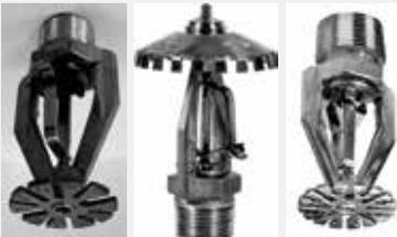
Спринклерные оросители типа ESFR-17 и ESFR-25 – быстродействующие оросители для раннего подавления огня, имеющие номинальный K-фактор 242 (16,8) и 363 (25,2) соответственно и работающие в режиме подавления пожара. Их наиболее выгодно применять в качестве средства защиты высокостеллажных складов без применения внутрительлажных оросителей.
